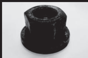
ホイールナットに生じた錆や付着したゴミ等 により、ワッシャーの摺動部が固着している。
